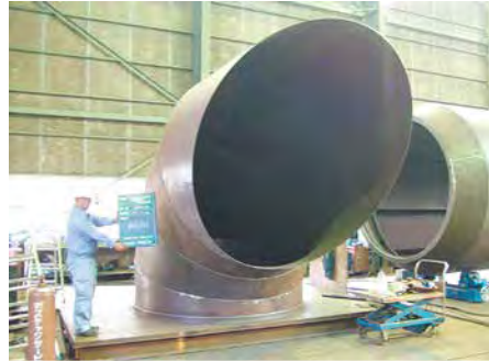
●放風サイレンサ (放風ダクト部)
